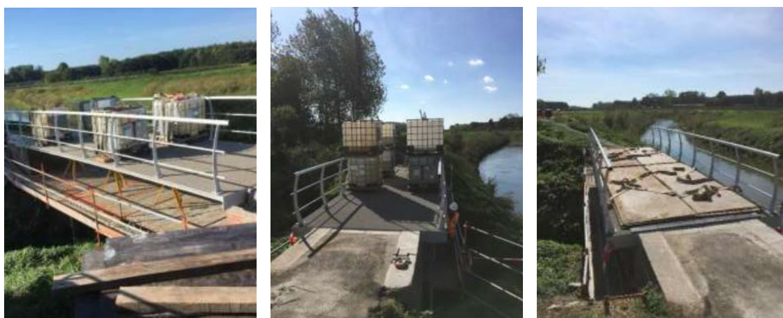
Figuur 2: Foto's van de uitvoering van de drie belastingsfasen voor de belastingsproef op de composietbrug in Tremelo
