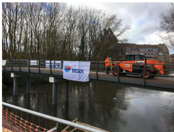
Figuur 5: Foto van de uitvoering van de belastingsproef met het 5,32 ton dienstvoertuig op de stroomafwaartse Canadabrug te Brugge
