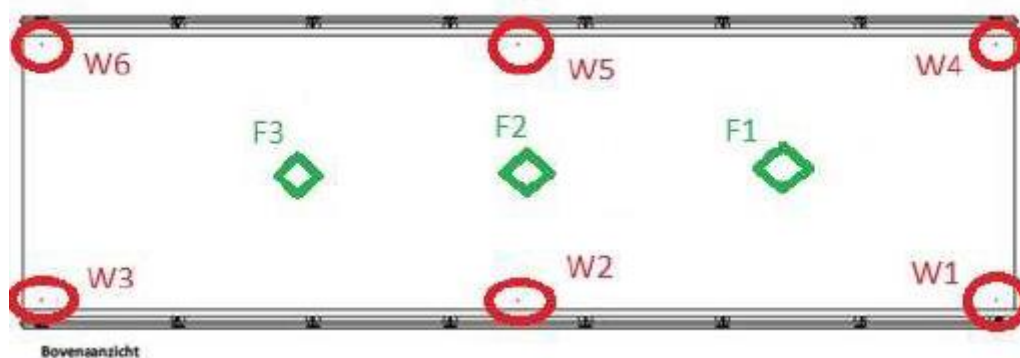
Figuur 3: Meetrooster en positionering van de meetpunten voor de opmeting van de doorbuiging tijdens de belastingsproef op de composietbrug in Tremelo
