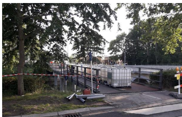
Figuur 14: Kwartstapkruipproef op stroomopwaartse Canadabrug te Brugge
